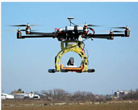
Квадрокоптер контролисан „кинектовом“ технологијом зајрашује прошив комараца и крпеља
