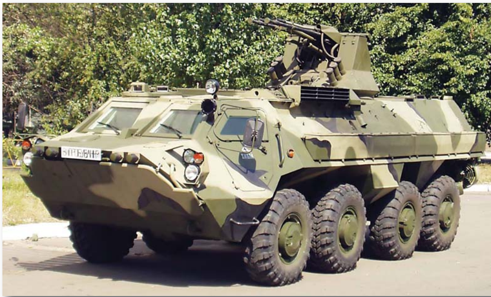
Занимљива верзија БТР-4 са куполом са два шоба 23 mm под називом „БАН-23x2“, која је првенствено намењена за противавионска дејства
